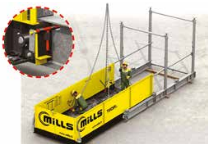
3 Lever le Tiroir en position ouverte, une fois les verrous enclenchés.
