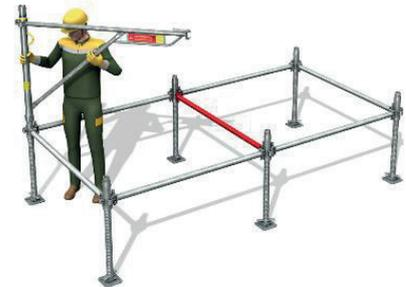
**2** Depuis l'intérieur de la tour, pose du 1<sup>er</sup> cadre d'entrée dans l'axe de la diagonale puis rotation pour le verrouiller.
