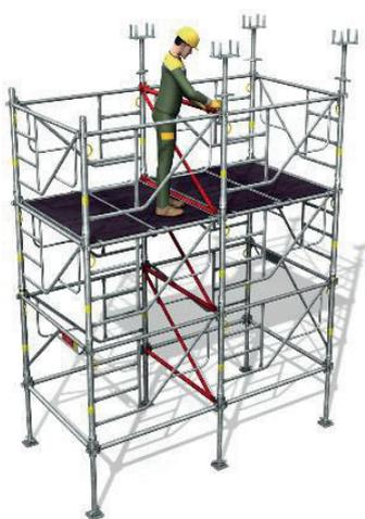
**12** Mise en place et réglages des vérins de tête. Contreventement impératif avec une moise et une diagonale.
