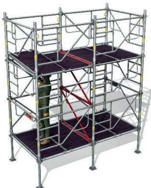
**10** Déplacement du 4<sup>e</sup> plancher à trappe depuis le niveau inférieur.
