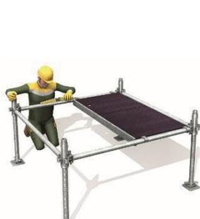
**1** Implantation et mise à niveau. Vérification de l'équerrage en poussant un plancher dans l'angle.
