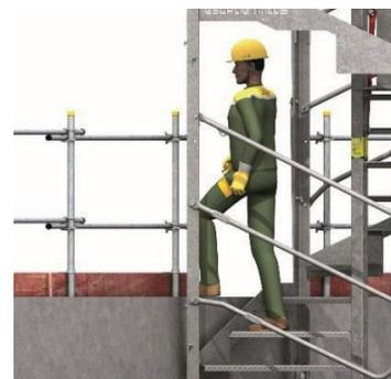
Idéalement, la dernière marche utilisée est placée 21 cm sous la dalle à desservir.
