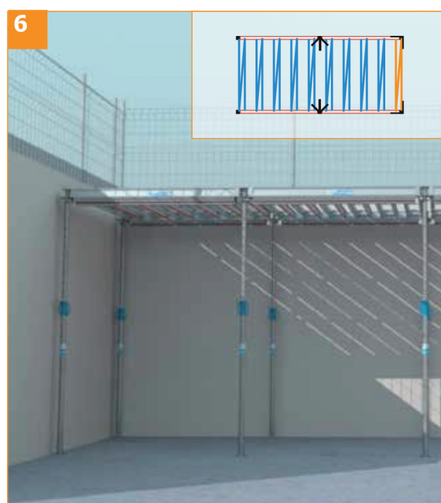
6 Terminer la mise en place des cadres secondaires.
